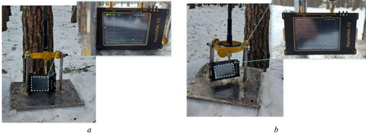
**Рис. 6.** Измерение коэффициента стоячей волны АУ AD-44 / CW-TA-30-512 в лесном массиве:
