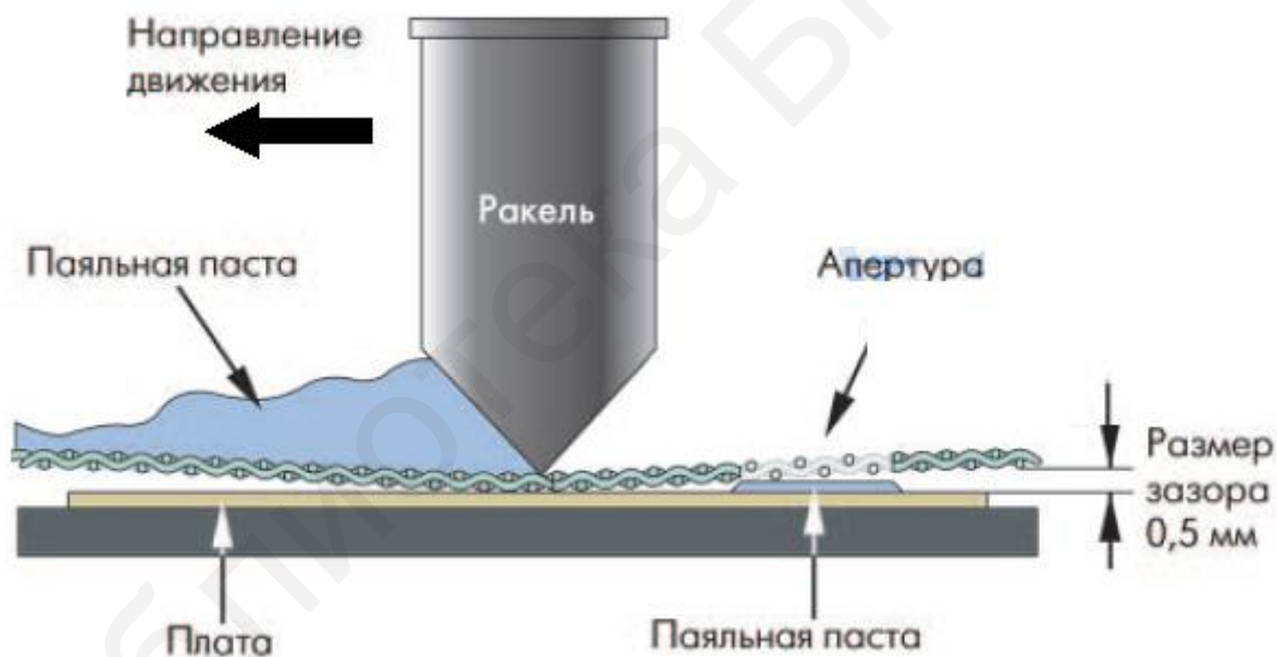
Рис. 4.4. Трафаретное нанесение пасты
