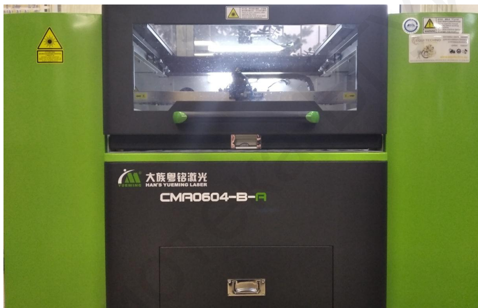
Рис. 3.7. Внешний вид установки лазерной резки CMA 0604-B-A
