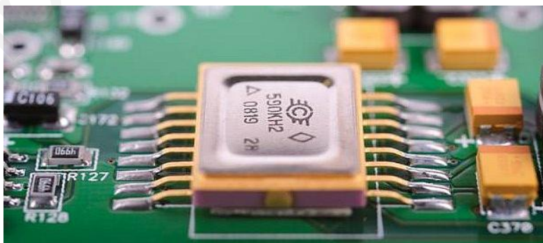
Рис. 4.9. Виды паяных соединений SMD
