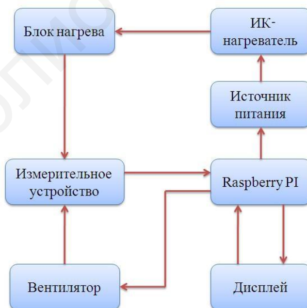
Рис. 5.4. Схема микропроцессорного управления термопрофилем ИК-нагрева
