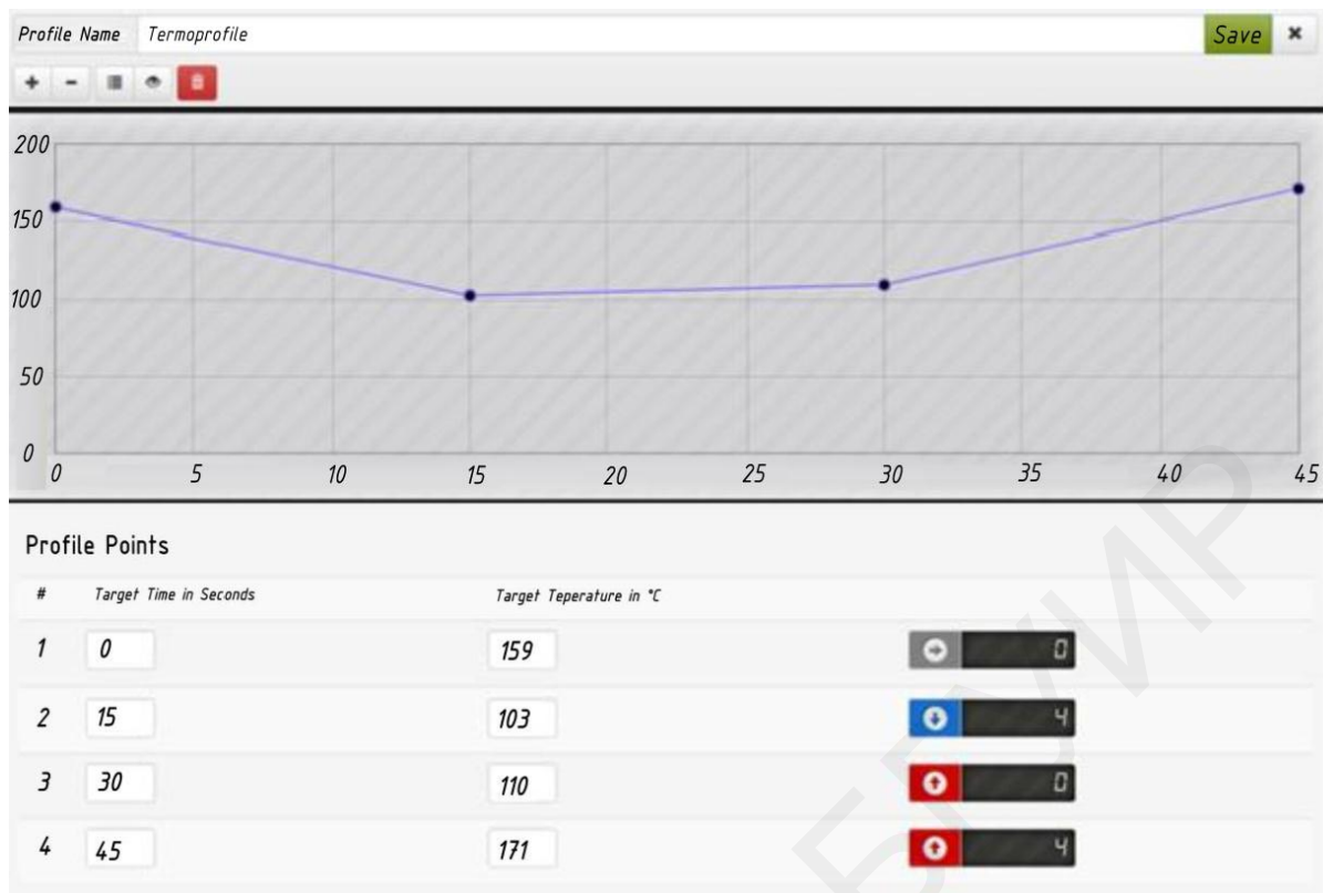
Рис. 5.7. Настройка термопрофилей оплавления паяльной пасты
