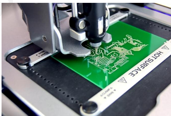
Рис. 2.5. Печать проводящего рисунка печатной платы специальными чернилами с высоким содержанием серебра
