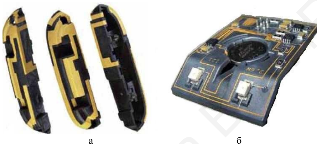
Рис. 1.2. Примеры 3D MID-изделий: а – антенна мобильного устройства; б – миниатюрное электронное устройство
