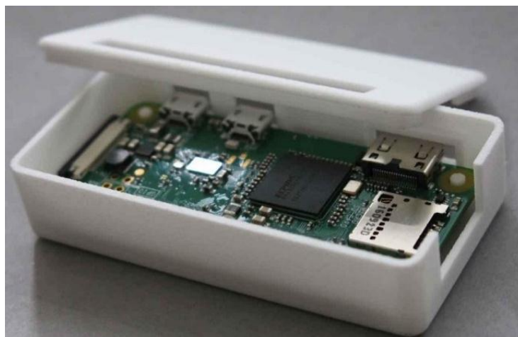
Рис. 2.9. Корпус электронного устройства, изготовленный методом FDM
