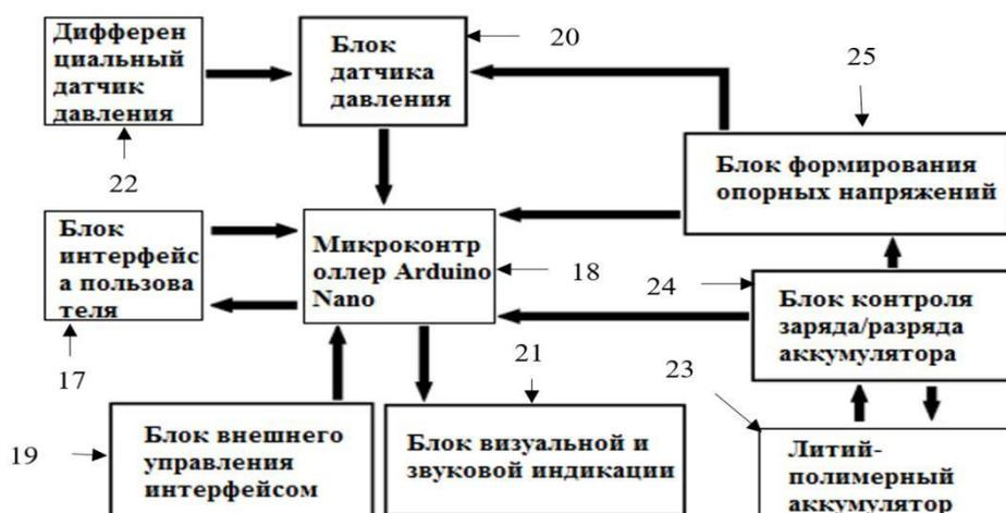
Манометр работает автономно от литий-полимерного аккумулятора (23), заряд и разряд которого контролирует блок (24) контроля
