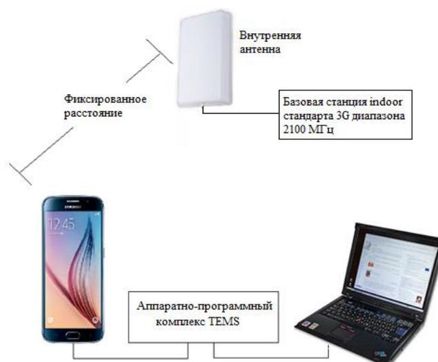
Рис. 1. Схема эксперимента по наблюдению за устанавливаемой мощностью излучения
