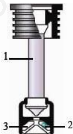
Рис. 2.4. Индикатор заряженности: 1 – световод; 2 – поплавок; 3 – короб
