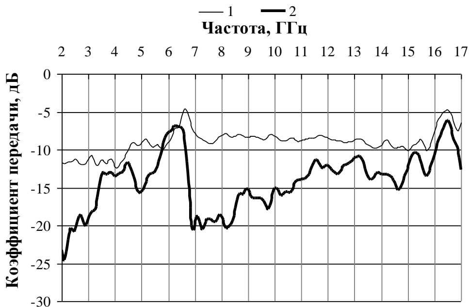
Рисунок 4.20 – Частотные зависимости коэффициента передачи ЭМИ изготовленных образцов в диапазоне 2–17 ГГц: 1 – образцы из партии 1; 2 – образцы из партии 2
