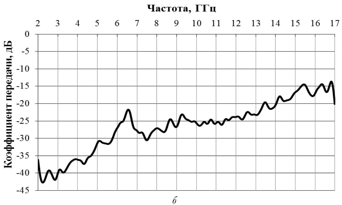
Рисунок 4.24 – Частотные зависимости коэффициента передачи ЭМИ в диапазоне в диапазоне 0,7–2,0 ГГц ( a ) и 2–17 ГГц ( б ) изготовленных образцов на основе никелированной анодированной фольги и иглопробивного материала (толщина – 0,7 см)
