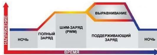
Рис. 2. 4-стадийный алгоритм заряда аккумулятора Fig. 2. 4-stage battery charging algorithm
