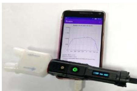
Рисунок 1 – Внешний вид микроконтроллерной системы измерения респирации
