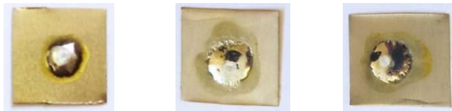
Рисунок 4 – Образцы растекаемости пасты на серебряном покрытии 0,6 мкм с содержанием УНТ 0,01% (а), 0,02% (б) и 0,03% (в)
