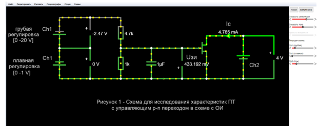
Рисунок 2 – Схема для исследования характеристик полевых транзисторов
