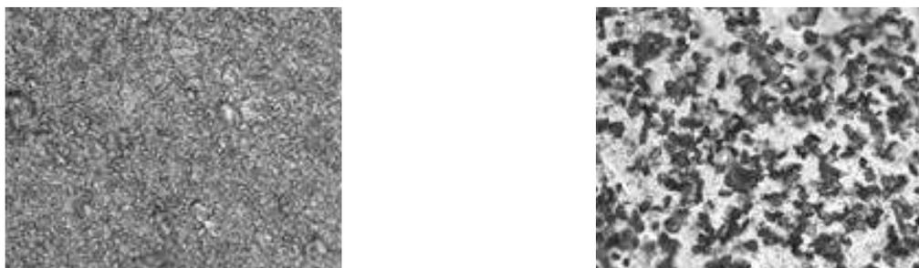
Рисунок 1 – Влияние дисперсной фазы на структуру покрытий: а – электролит без дисперсной фазы, б – электролит с частицами углерода
