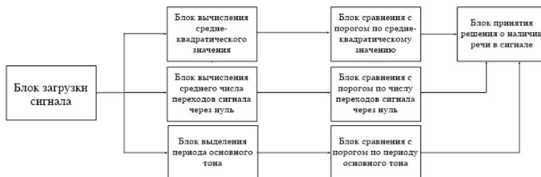
Рисунок 1 – Структурная схема модуля распознавания речи
