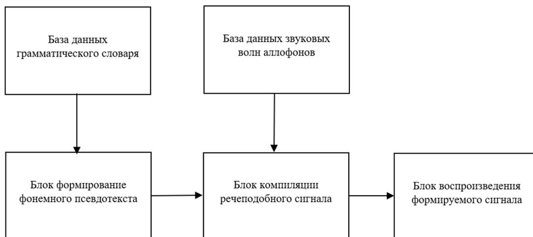
Рисунок 1 – Структурная схема модуля защиты речевой информации
