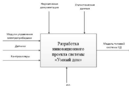
Рисунок 1 – Модель «черного ящика» для системы «Умный дом»
