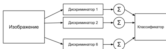
Рисунок 6 – Архитектура RAM-сети для определения сектора.
