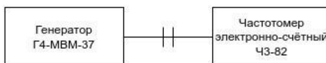
Рисунок 1 – Схема соединения приборов при определении погрешности установки и нестабильности частоты.
