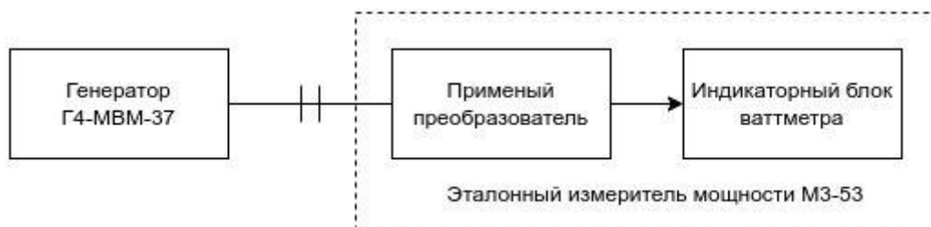
Рисунок 2 – Схема соединения приборов при определении погрешности установки уровня мощности выходного сигнала.
