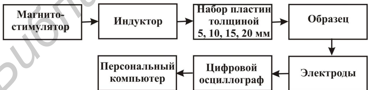
Рисунок 1. – Структурная схема установки для измерений влияния импульсного магнитного поля на образцы
