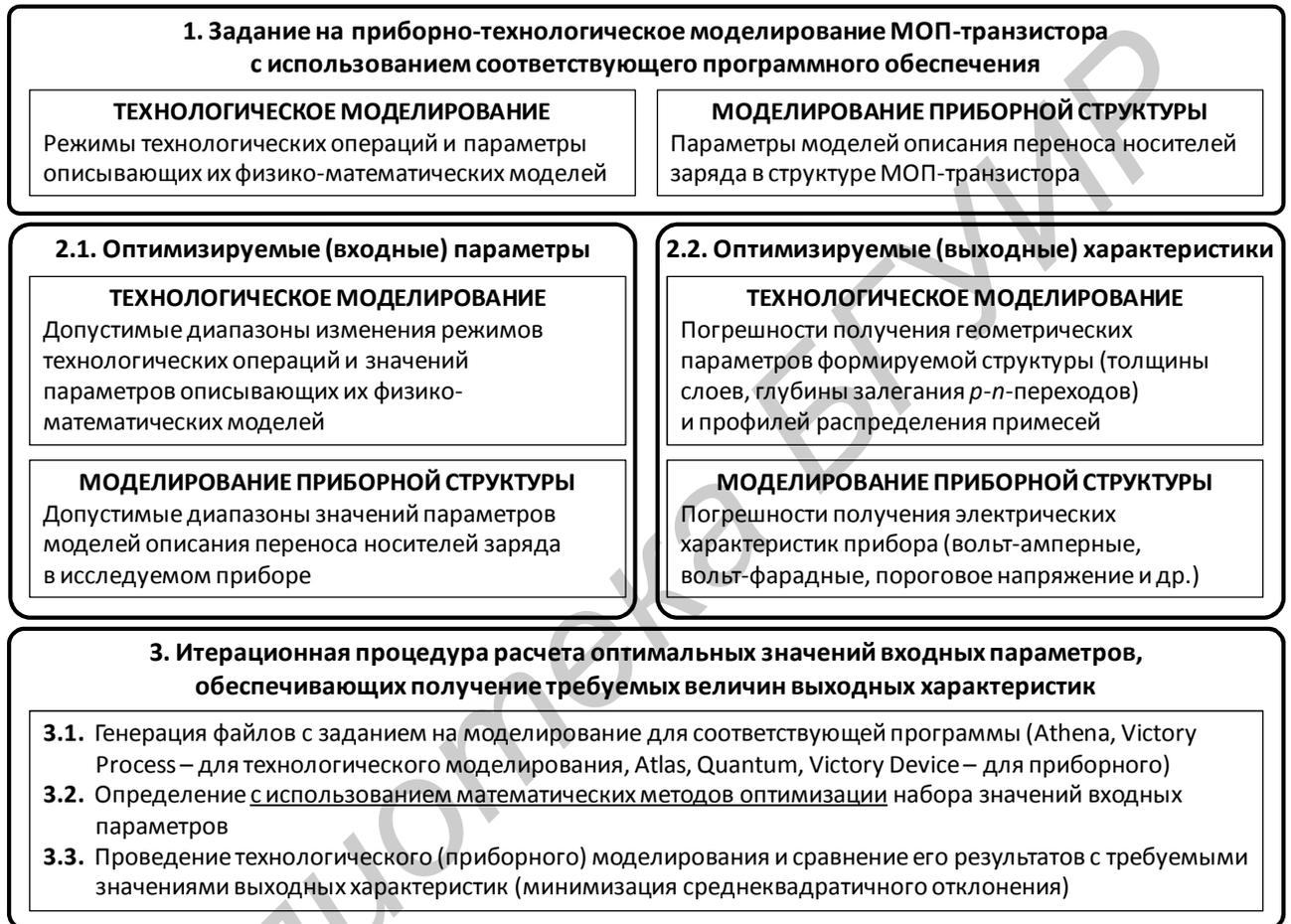
**Рисунок 2. – Блок-схема реализации методики оптимизации режимов технологического процесса, настройки и верификации параметров физико-математических моделей технологических операций и переноса носителей заряда**
