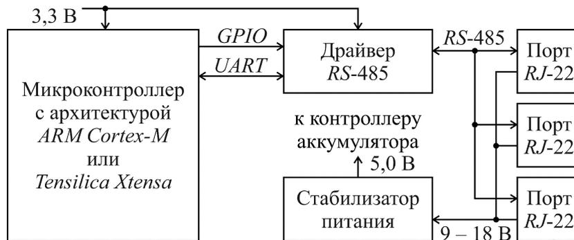
Рисунок 31 – Связь *RS-485* с *UART* в микроконтроллерной системе
