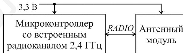
Рисунок 32 – Структурная связь антенного модуля с микроконтроллером со встроенным радиоканалом
