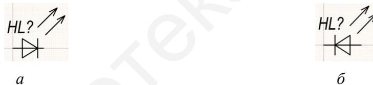
Рисунок 55 – Основное (а) и альтернативное (б) изображения светодиода на принципиальной электрической схеме
