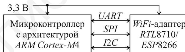
Рисунок 18 – Фрагмент структурной схемы управления *WiFi*-адаптерами
