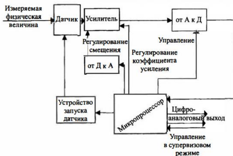
Рисунок 5 – Архитектура датчиков со встроенным микропроцессором
