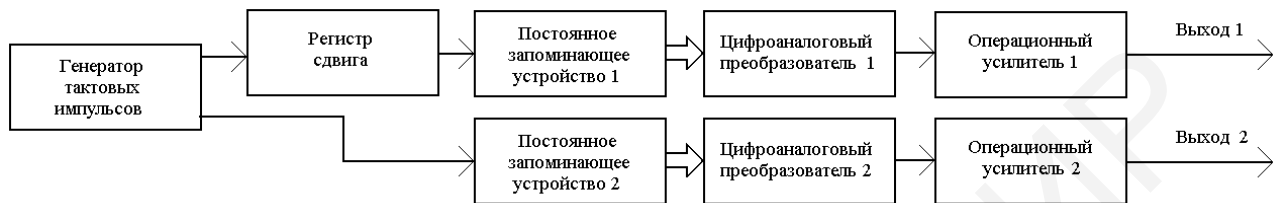
Рисунок 2.9 – Структурная схема двухканального измерительного генератора с регулируемым фазовым сдвигом
