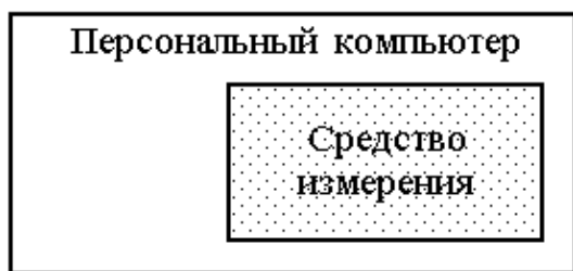
Рисунок 1.4 – КИС как ПК со встроенным СИ
