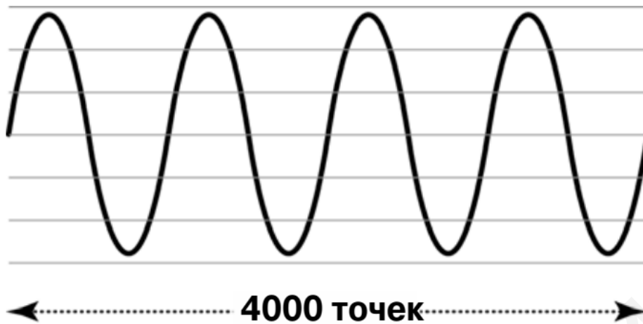
Рисунок 2.7 – Изображение синусоидального сигнала, сформированного генератором при частоте дискретизации 4000 выборок в секунду и четырех периодах сигнала
