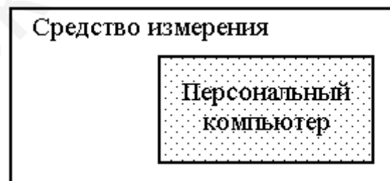
Рисунок 1.3 – КИС как СИ со встроенным ПК
