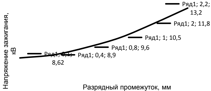
Рисунок 4 – Зависимость напряжения зажигания плазмы от расстояния между электродами
