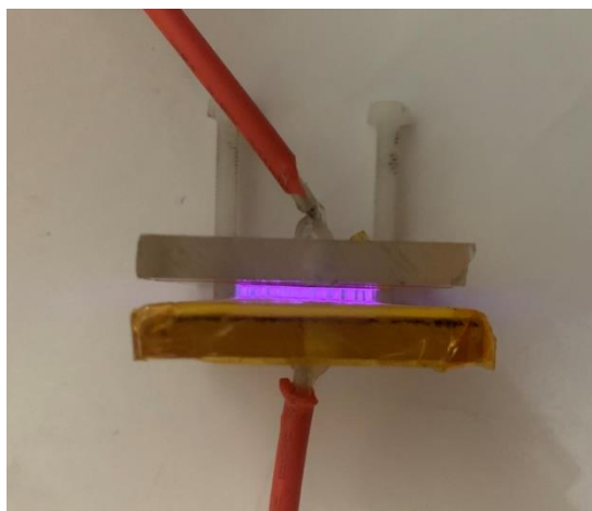
Рисунок 2 – Внешний вид разрядной системы диэлектрического барьерного разряда
