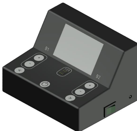
Рисунок 2 – 3D- модель измерителя характеристик полупроводниковых приборов
