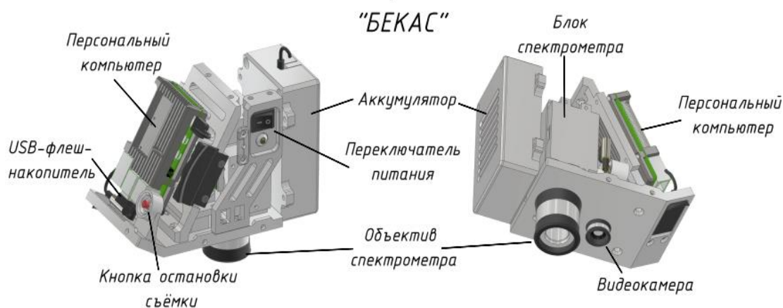
3-Д изображение БЕКАС, вид слева 3-Д изображение БЕКАС, вид снизу производится через интерфейс USB с пассивным питанием.
