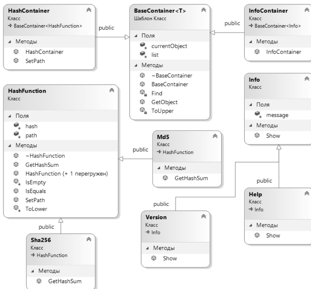
Рисунок 1 – Упрощённая диаграмма классов разработанного программного средства
