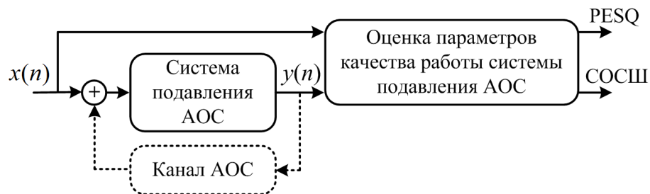
Рисунок 14. – Схема тестирования системы подавления АОС
