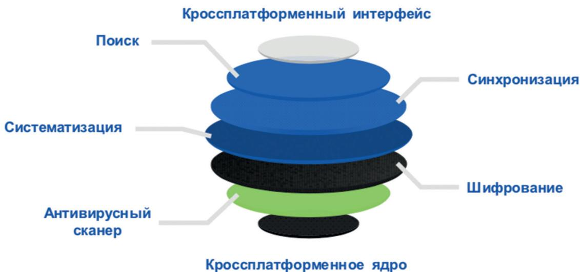
Рис. 1. Общая схема логических слоев криптоконтейнера
