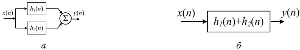
Рисунок 2.2 – Параллельное соединение линейных стационарных систем (а); система, эквивалентная системе а (б)
