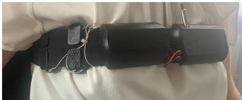
Рисунок 6 – Устройство системы мониторинга параметров здоровья человека
