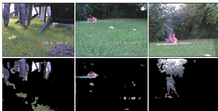
Рис. 2. Примеры извлечения объектов из кадров видеопотока робота Wifibot-M во время эксперимента с огнем: человеческие ноги, огонь, задымление
