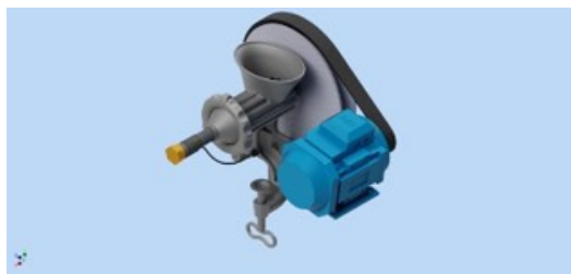
Рис. 2 – 3D-модель устройства вторичной переработки пластика
