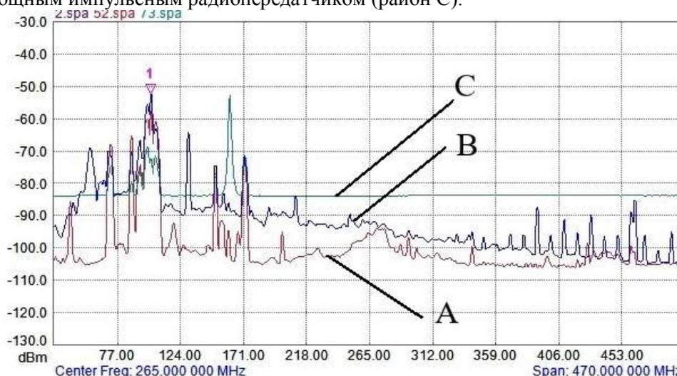
Рисунок 1 – Спектрограммы максимальных мгновенных значений уровней помех и шумов в полосе шириной 1 МГц на Е поляризации в диапазоне метровых длин волн для сельскохозяйственного (А) и промышленного (В) районов и полигона (С)
