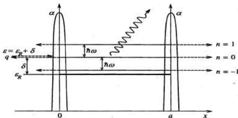
Рисунок 1 – Двухбарьерная структура с резонансным уровнем  $\epsilon_R$ .
