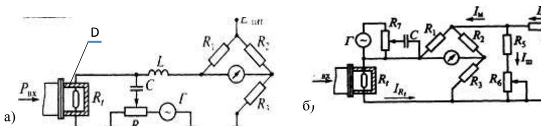
Рисунок 1 – Неуравновешенный (а) и уравновешенный (б) мост измерения мощности СВЧ сигнала
