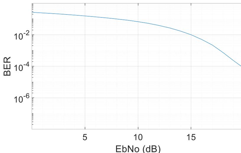
Рисунок 2 – Производительность BER ACO-OFDM 64QAM
