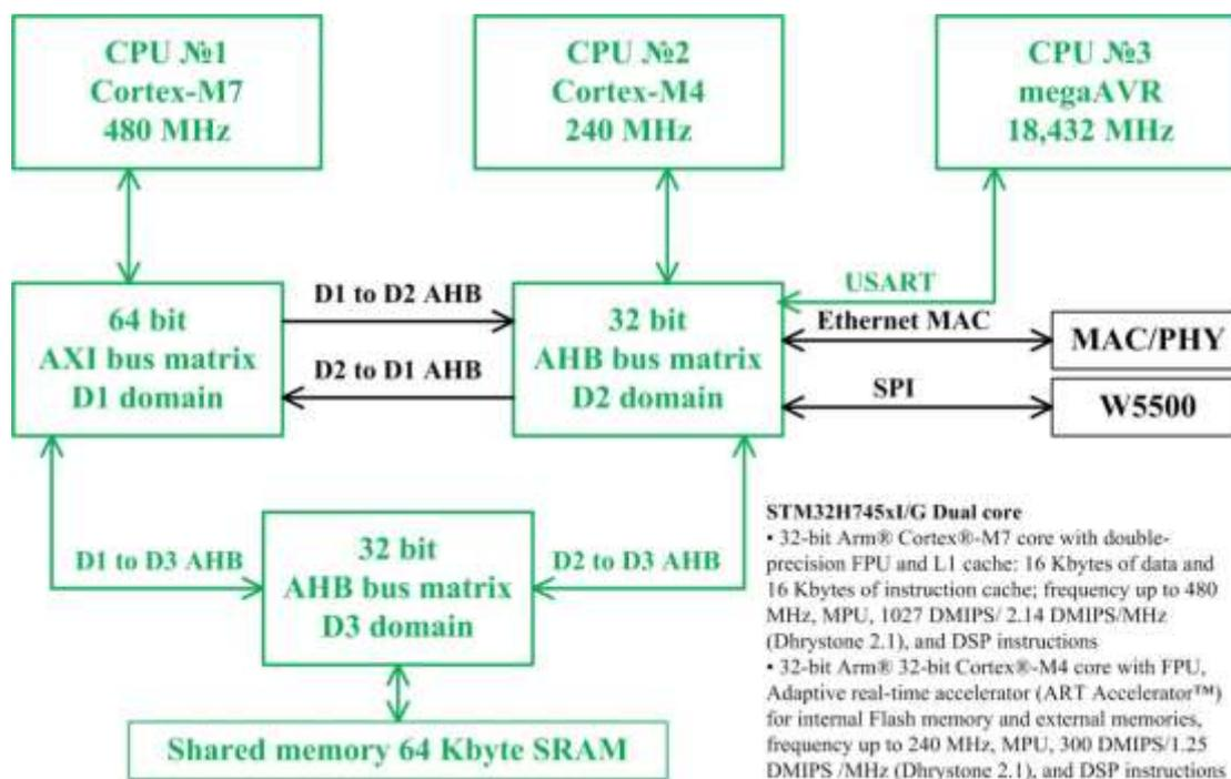
Рисунок 1 – Мультипроцессорная архитектура гетерогенного шлюза
