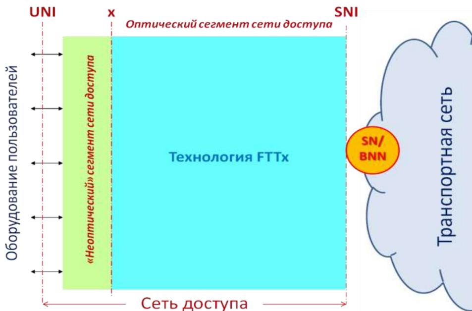
Рисунок 2 – Обобщенная схема сети доступа с применением технологии FTTx
