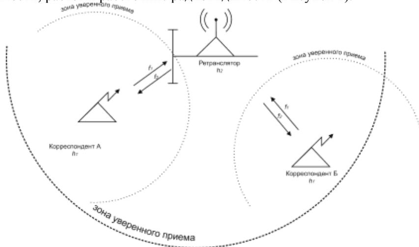
Рисунок 1 – К иллюстрации ретрансляции радиосигналов
