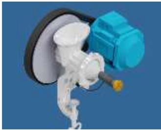
Рисунок 1 – 3D-модель устройства вторичной переработки пластика
