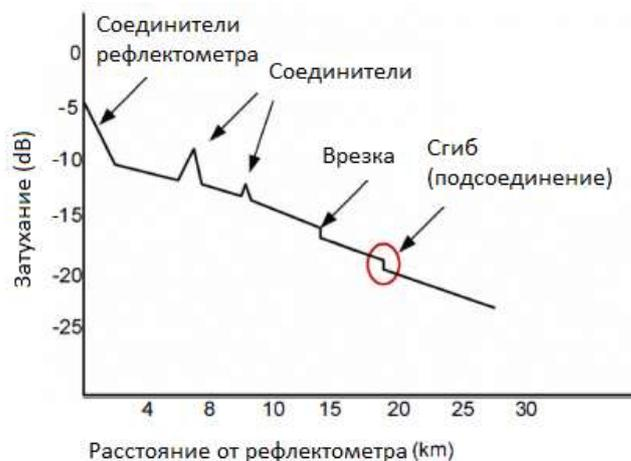
Рисунок 7 – Поиск несанкционированного подключения на оптической трассе с помощью оптического рефлектометра
