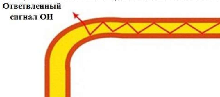
Рисунок 2 – Схема создания макроизгиба оптического волокна
