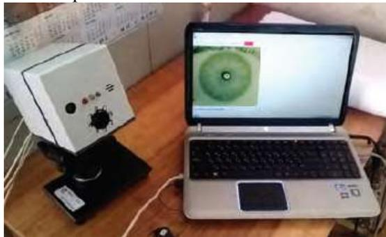
Рисунок 1 – Программно-аппаратный комплекс НАН РБ 2015 года для идентификации личности по радужной оболочке глаза (слева – иридоанализатор, справа – компьютер для обработки данных сканера)
