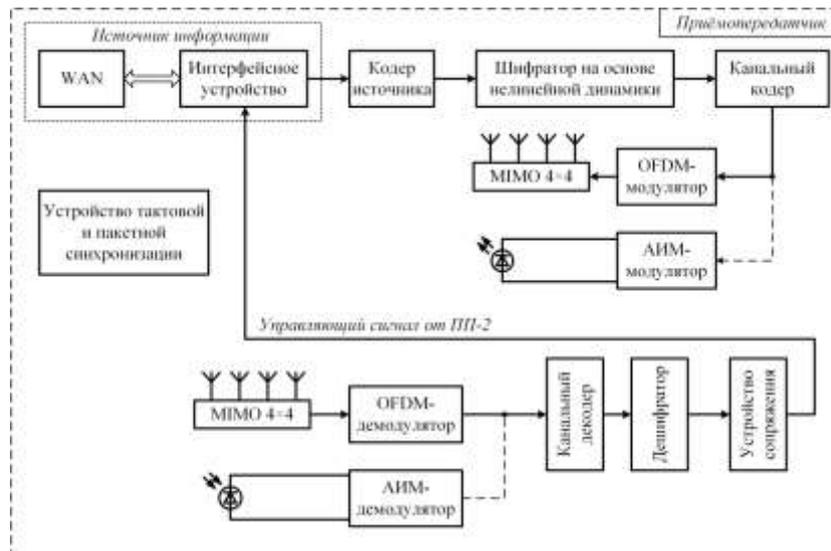
Рисунок 1 – Обобщенная структурная схема устройства приема-передачи цифрового потока
