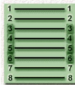
Рисунок 2 – Пример показаний простого кабельного тестера
