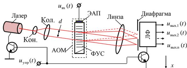
Рисунок 4 – Акустооптическая система оконного преобразования Фурье
