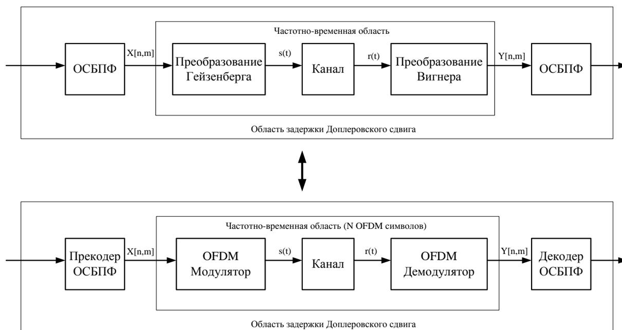
Рисунок 2 – Структурная схема системы связи OTFS (модулятор и демодулятор)
