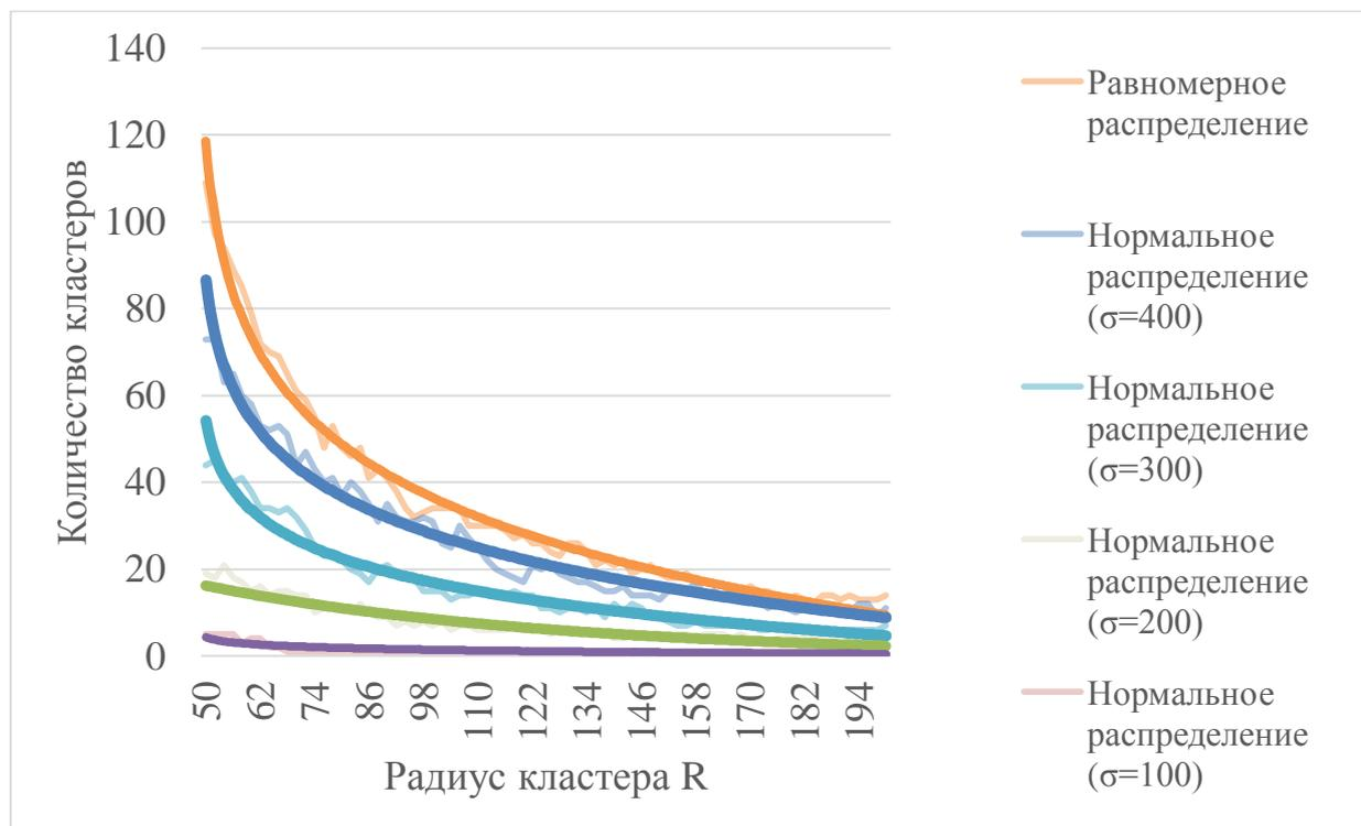
Рисунок 1 – График зависимости количества кластеров от закона распределения узлов
