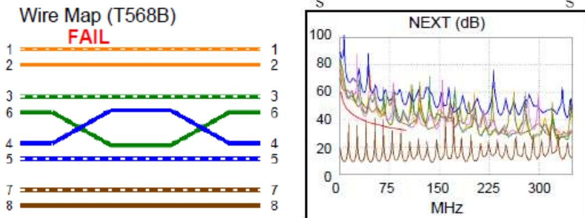
Рисунок 3 – Показания тестера DSX-5000 при ошибке «расщепленная пара»
