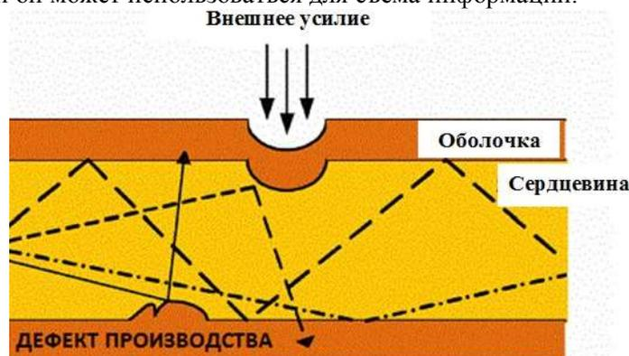
Рисунок 1 – Схема создания микроизгиба оптического волокна
