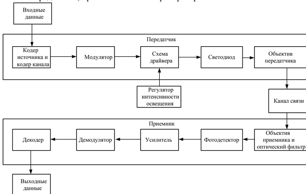
Рисунок 1 – Система передачи данных Li-Fi
