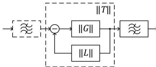
Рисунок 1 – МШУ с ООС в составе преселектора метрового диапазона
