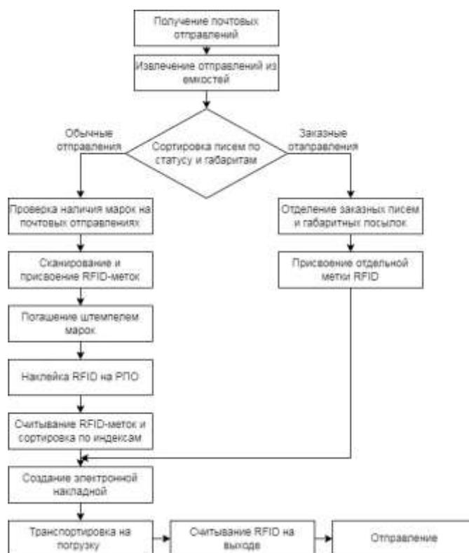
Рисунок 1 – Алгоритм функционирования сортировочного конвейера с применением RFID системы
