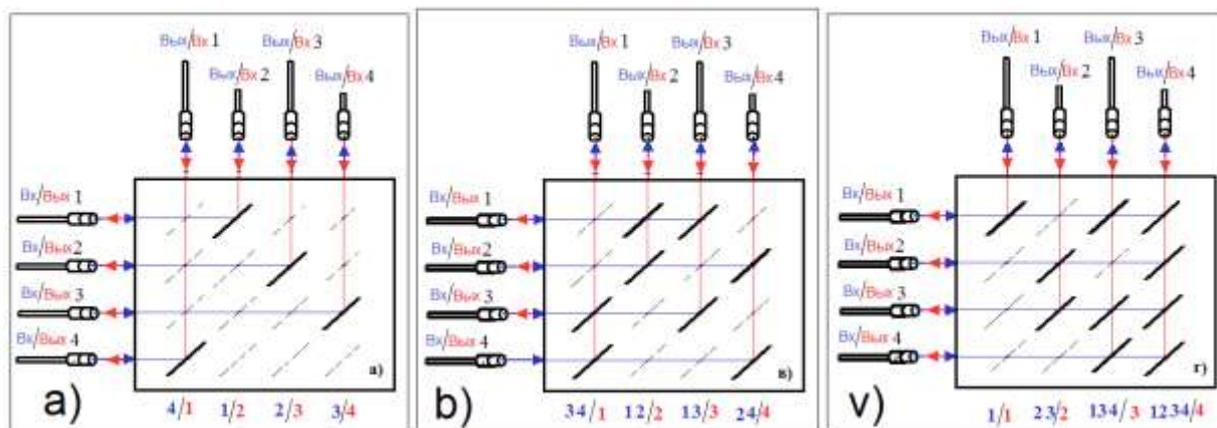
Рисунок 1 – Варианты коммутации и мультиплексирования информационных потоков на основе подвижных Smart зеркал
