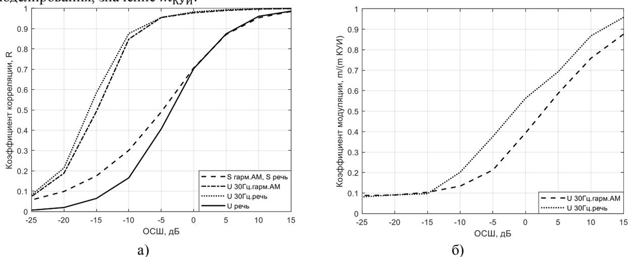
Рисунок 2 – Результаты моделирования при различных уровнях шума, сравнение: а)  $R$ ; б)  $m$
