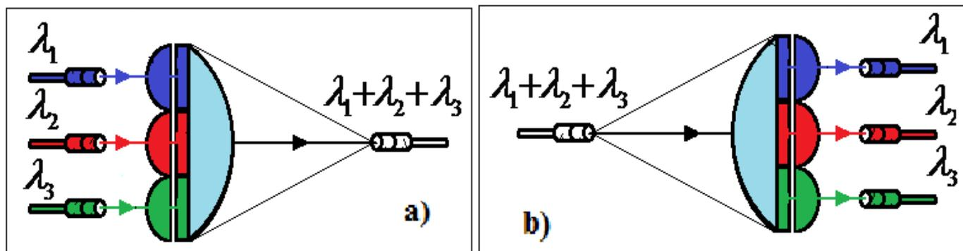
Рисунок 2 – Технология коммутация и мультиплексирования световых потоков на основе фокусирующих линз
