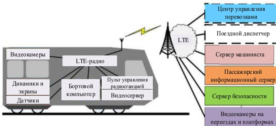
Рисунок 1 – Общий вид взаимодействия «поезд – центр управления» в сети LTE
