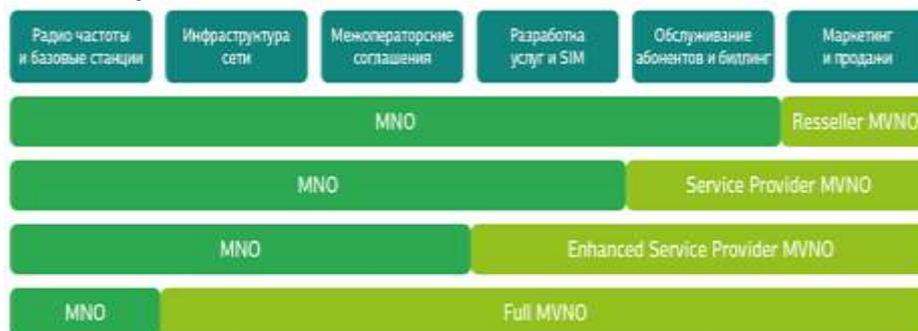
Рисунок 1 – Типы операторов MVNO
