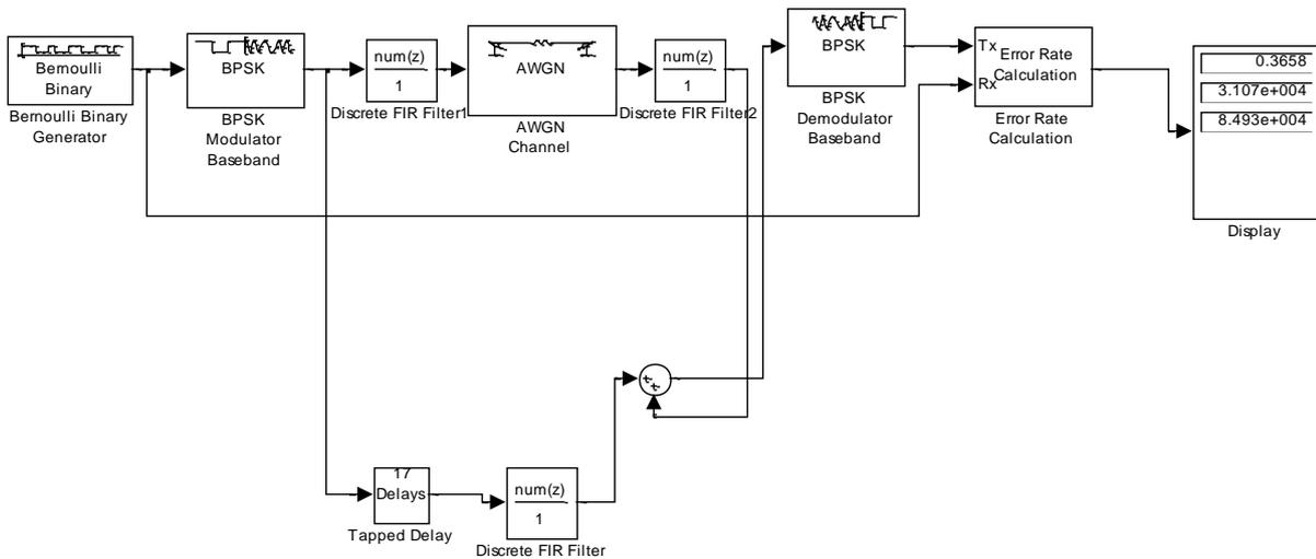
Рисунок 1 – Схема канала связи
