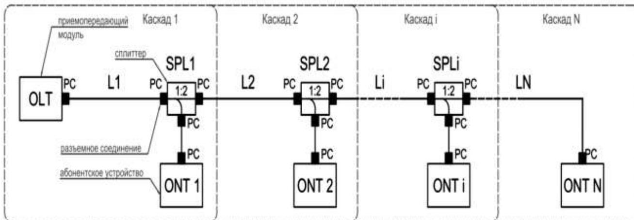
Рисунок 2 – Структурная схема сети связи с применением технологии GPON
