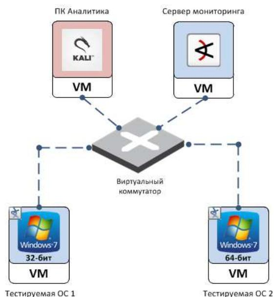
Рисунок 1 – Макет виртуального стенда
