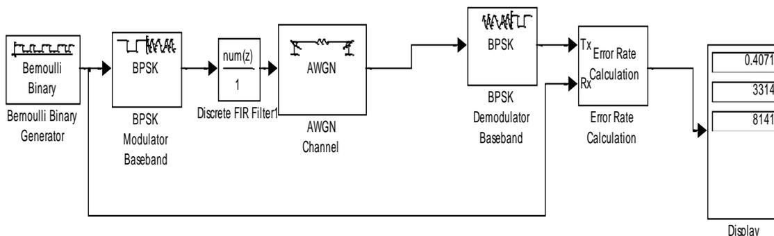
Рисунок 1 – Схема канала связи
