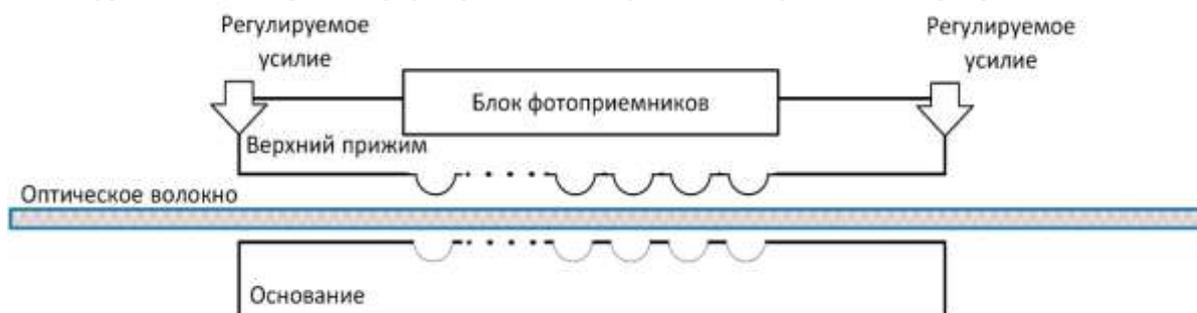
Рисунок 1 – Конструкция используемого формирователя микроизгибов
