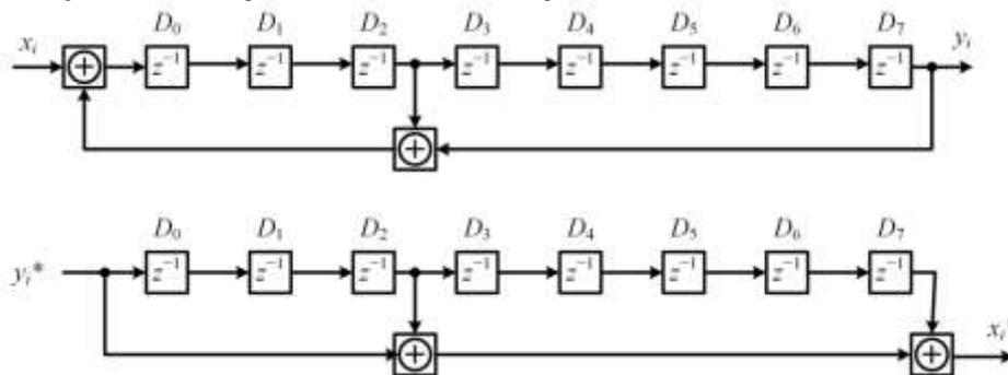
Рисунок 1 – Мультипликативный скремблер (вверху) и соответствующий ему дескремблер (внизу)
