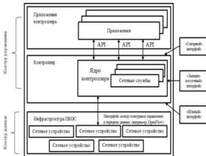
Рисунок – Структура фрагмента (одного домена) программно-конфигурируемой оптической сети
