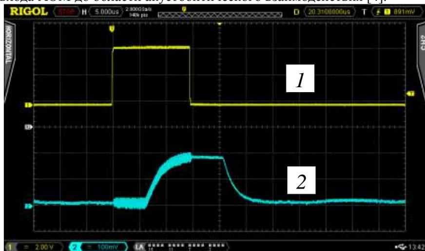
Рисунок 2 – Осциллограммы напряжений на входе формирователя (1) и на выходе ФД-24К (2)
