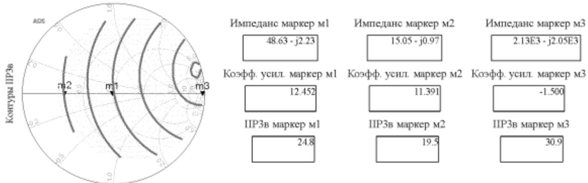
Рисунок 2 – Зависимость  $IP3$  МШУ на основе  $pHEMT$  СВЧ МИС  $MGA62563$  от внеполосного импеданса нагрузки в составе преселектора метрового диапазона
