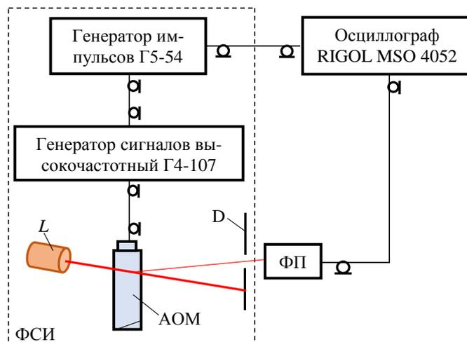
Рисунок 1 – Схема экспериментальной установки
