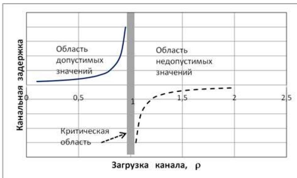
Рисунок 1 – Разрывная функция канальной задержки
