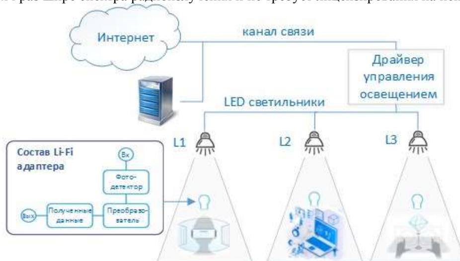
Рисунок 1 – Применение Li-Fi технологии для VR и AR устройств
