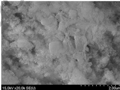
Рис. 4. Фотография поверхности кремниевого кристалла после выгорания пористого кремния
