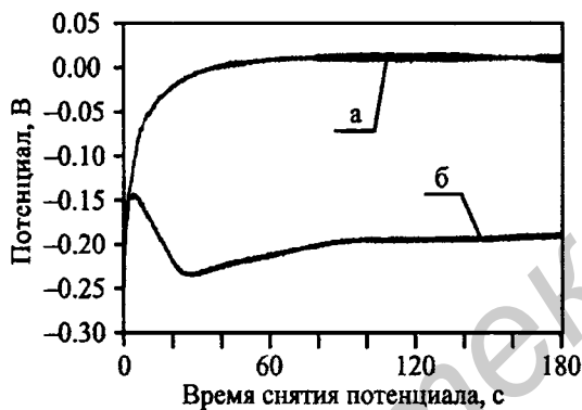
Рисунок 1 – Зависимости потенциала поверхности монокристаллического кремния и ПК от времени осаждения меди
