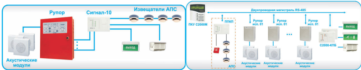
Рисунок 3 – СОУЭ 3-го типа с использованием оборудования «Болид»
