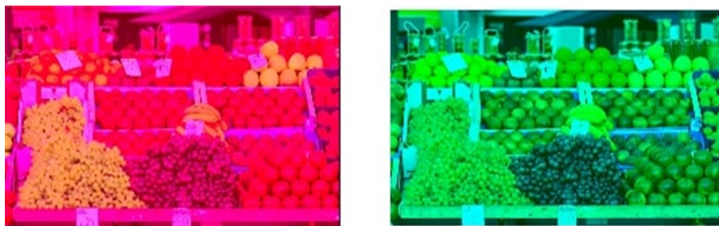
Рисунок 6. Результат перемножения изображения в L^*a^*b^* с матрицей преобразования при n = 2, k = l = 1 и n = -2, k = l = 1
