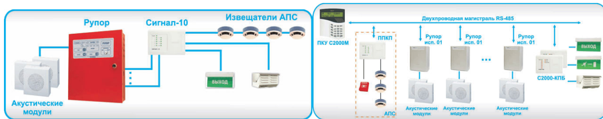
Рисунок 3 – СОУЭ 3-го типа с использованием оборудования «Болид»
