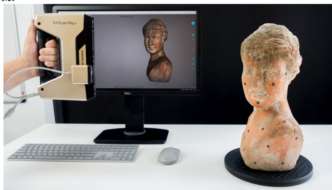
Рисунок 2 – Принцип работы лазерного 3D-сканера [5]
