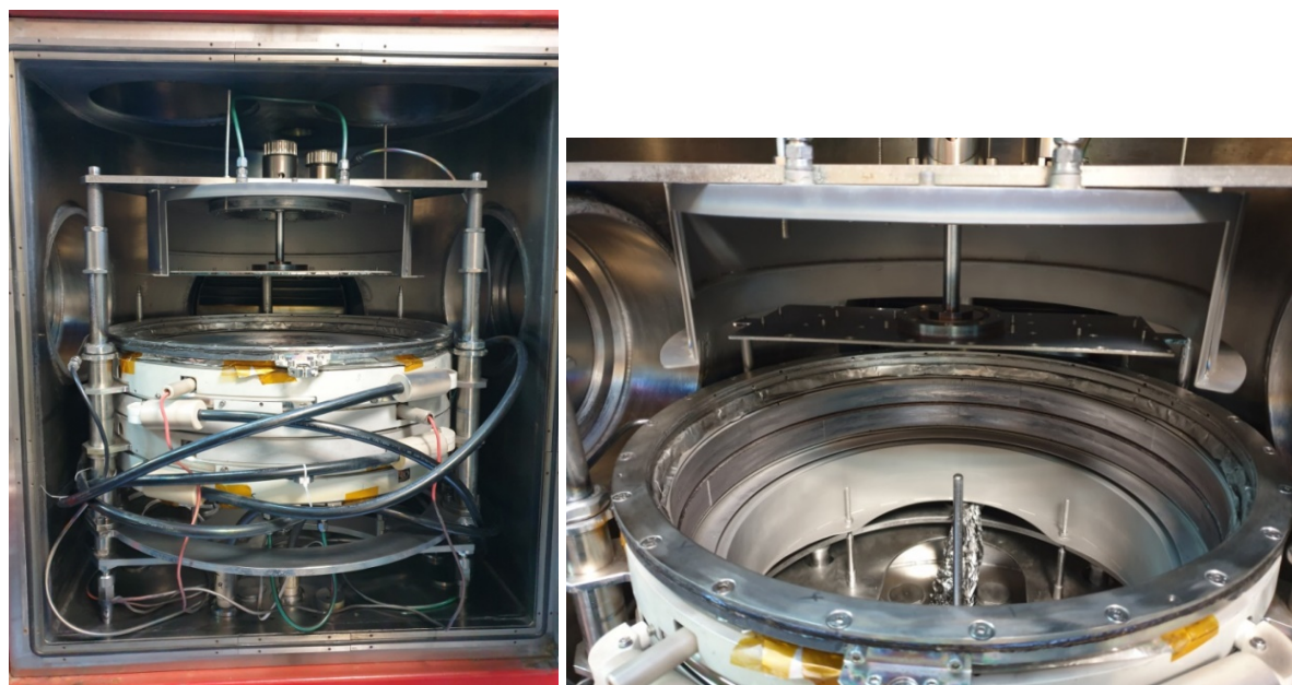
Рисунок 1 – Общий вид внутрикамерной оснастки для нанесения интерференционных покрытий методом реактивного магнетронного распыления
