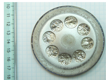
Рисунок 2 – Внешний вид Ti-Zr мозаичной мишени
