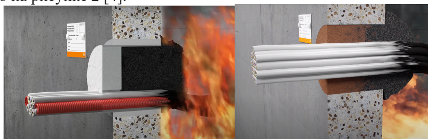
Рисунок 2 – Расширение материалов проходок при воздействии огня
