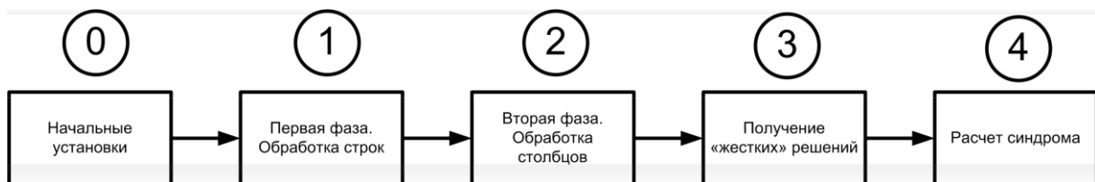
Рисунок 1 – Этапы декодирования блочного турбо кода
