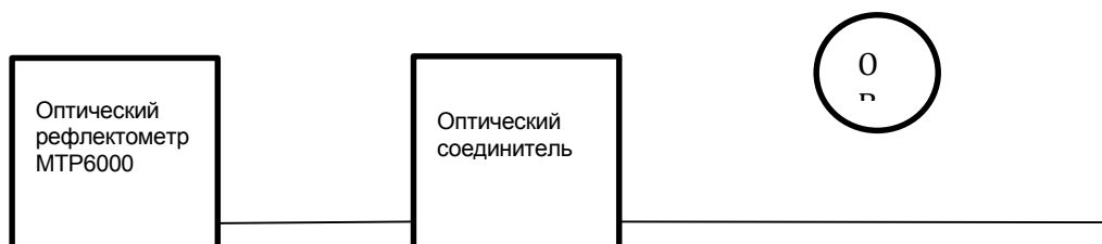
Рисунок 1 - Схема подключения оптического волокна к рефлектометру.
