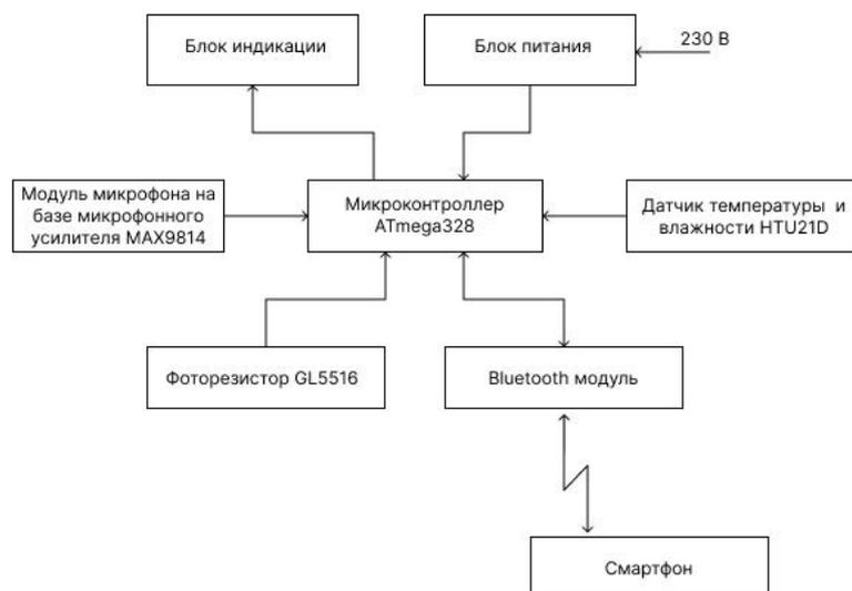
Рисунок 1 – Схема электрическая структурная
