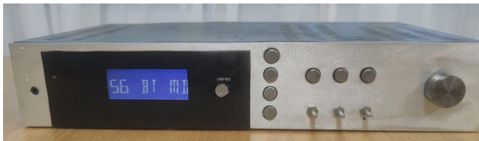
Рисунок 8 – Готовый усилитель звука с цифровым управлением
