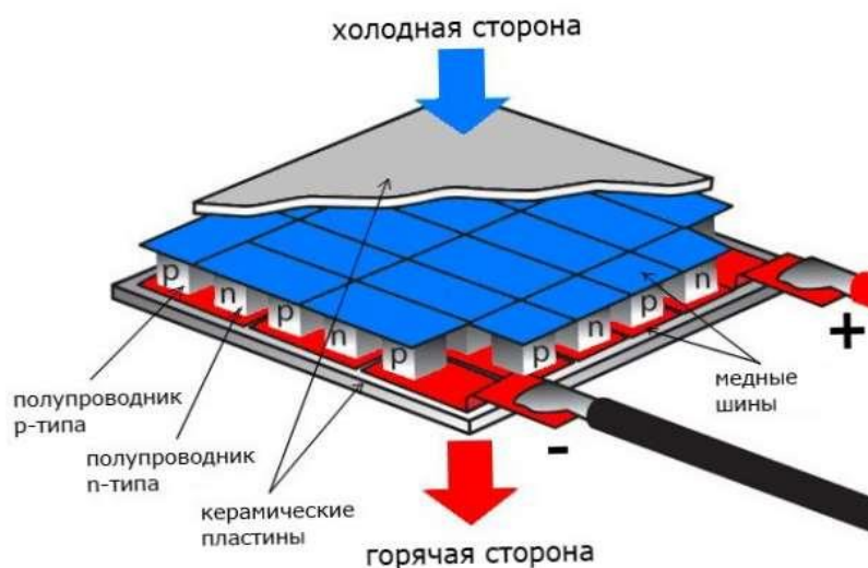
Рисунок 2 – Принцип работы модуля Пельтье
