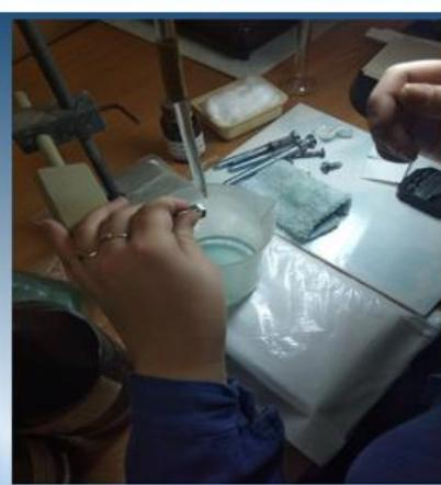
Контроль толщины покрытия по ГОСТ 9.302-88 – оператор-гальваник
