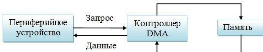
Рисунок 1.10 – Схема использования DMA
