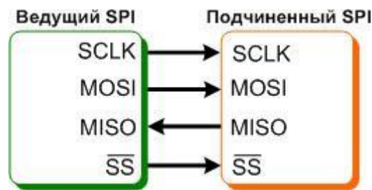
Рисунок 1.9 – Схема простого подключения с использованием SPI
