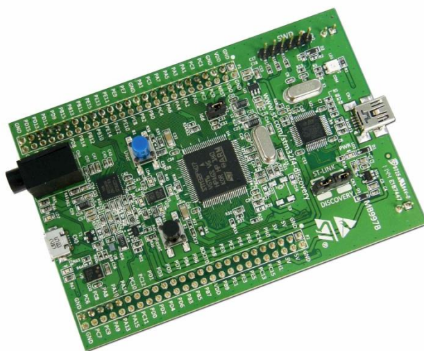
Рисунок А.3 – Внешний вид платы STM32F4 Discovery
