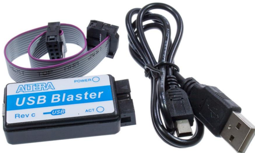
Рисунок 2.6 – Загрузочный кабель для программирования ПЛИС типа CPLD и FPGA компании Altera USB Blaster Rev.c
