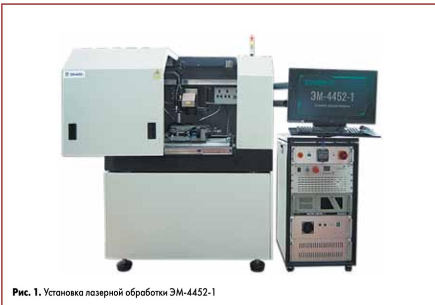
Рис. 1. Установка лазерной обработки ЭМ-4452-1
