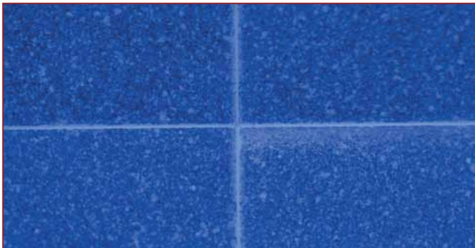
Рис. 3. Внешний вид планарной стороны кристаллов после разделения
