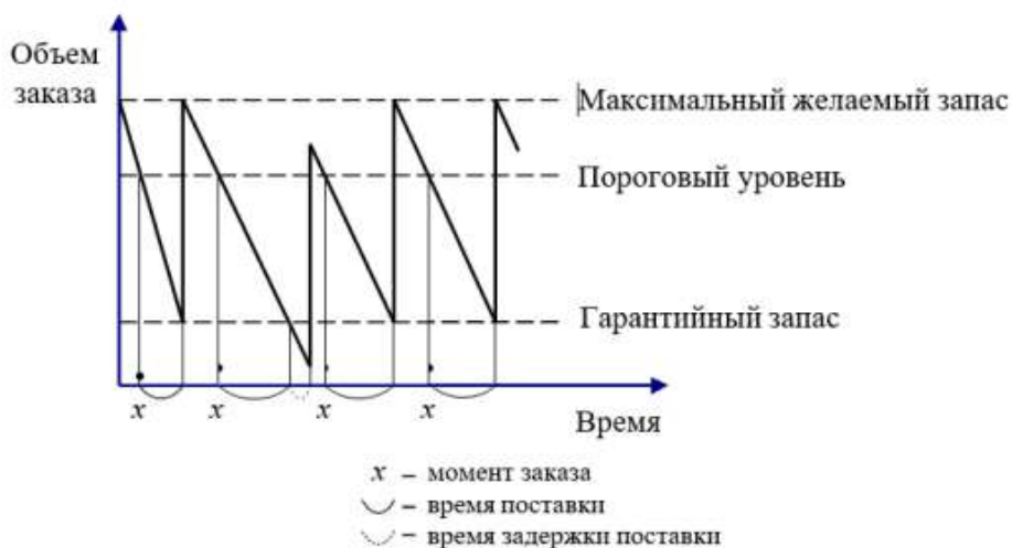
Рисунок 4 – Система управления запасами с фиксированным размером заказа
