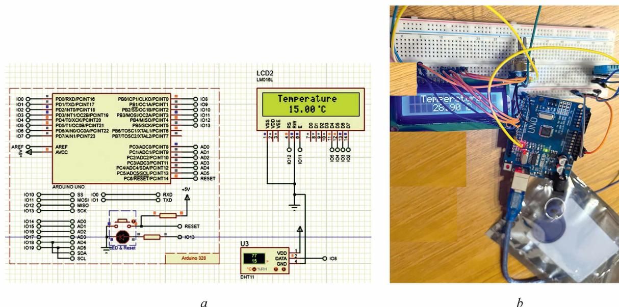
**Рис. 1.** Результаты учебного проектирования цифрового устройства контроля и индикации технологического параметра: *a* – результат симуляции на удаленном устройстве члена проектной группы; *b* – макет устройства в лаборатории
