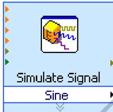
Рисунок 1.4 – Функция экспресс-ВП – моделирование сигнала
