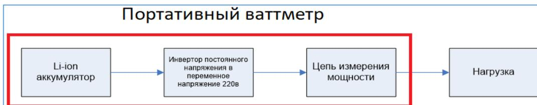
Рисунок 1 – Схема прибора
