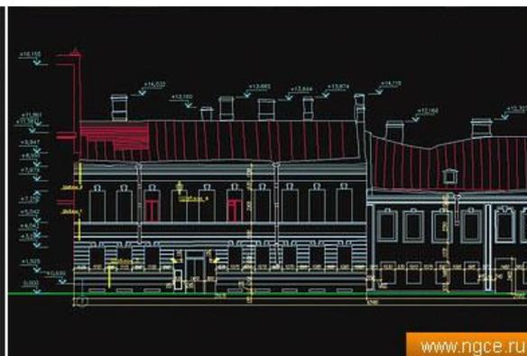
Рис. 8.9. 3D-модель, созданная по итогам процесса лазерного сканирования
