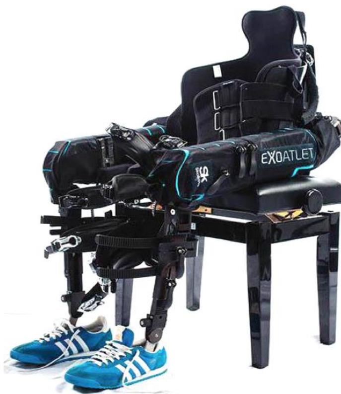
Рис. 18.15. Роботизированный экзоскелет, управляющийся импульсами нервной системы человека
