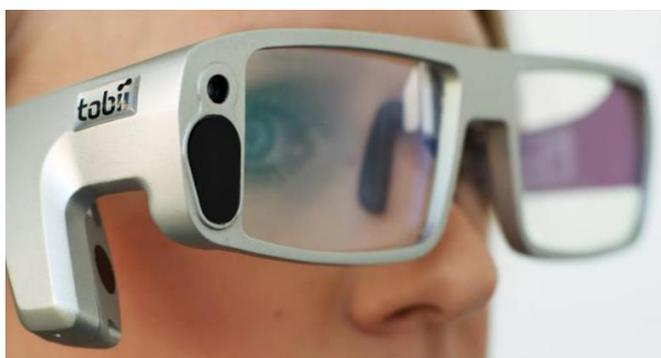
Рис 13.1 Устройство для отслеживания движения зрачков
