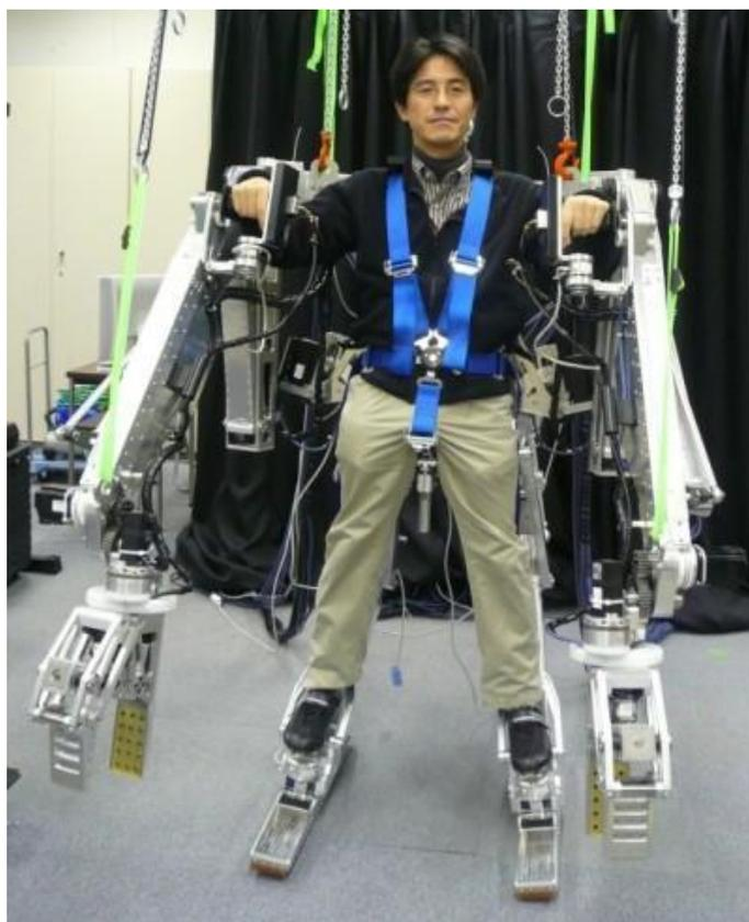
Рис. 18.16. Экзоскелет с тактильной обратной связью системы Power Loader
