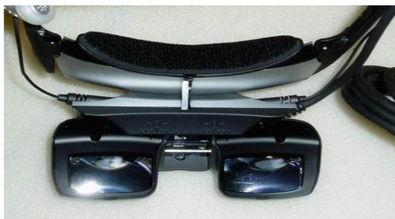
Рис. 9.15. Шлем виртуальной реальности eMagin Z800 3DViso со встроенным трекером
