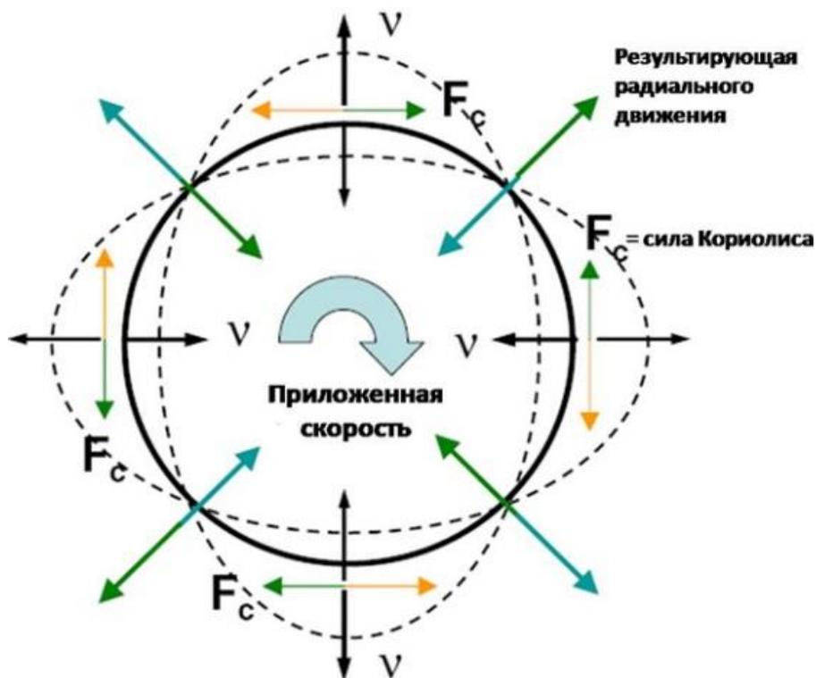
Рис. 7.14. Принцип действия гироскопа
