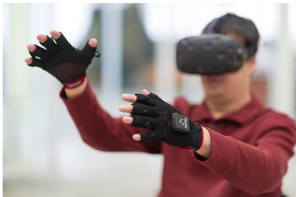
Рис. 6.4. Перчатки виртуальной реальности со световыми сенсорами
