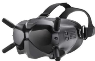
Рис. 7.15. Очки виртуальной реальности для FPV-управления
