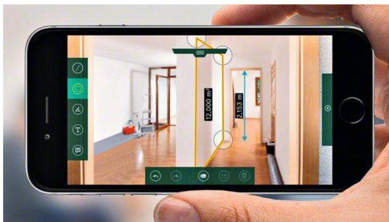
Рис. 12.3. Измерение объектов с помощью AR
