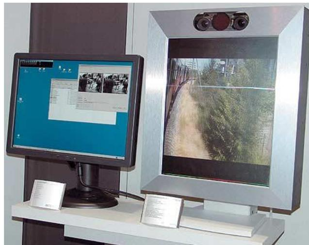
Рис. 10.3. Стереоскопический 3D-дисплей
