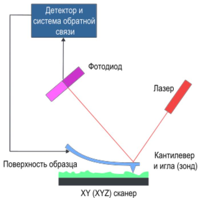
Рис. 18.2. Схематическое изображение зондового датчика АСМ
