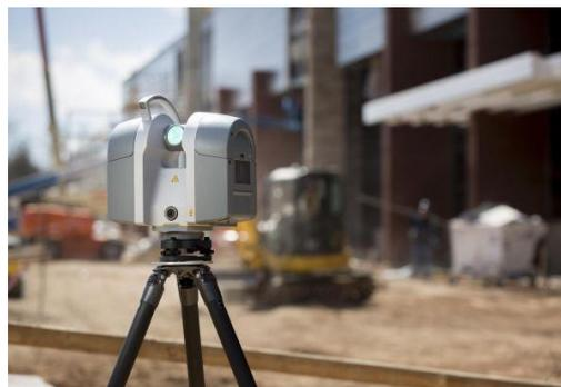
Рис. 8.7. Сканеры лазерные
