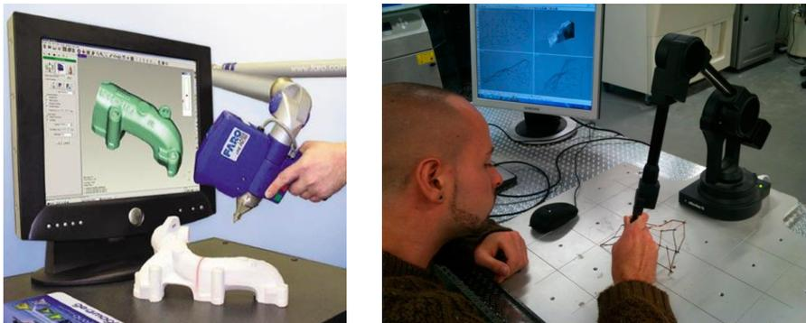
Рис. 8.4. Примеры контактного сканирования
