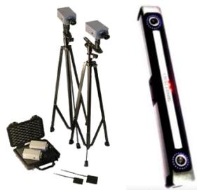
Рис. 7.4. Устройства оптического трекинга с маркерами
