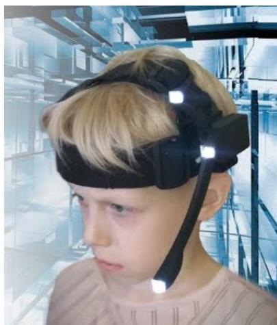
Рис. 6.7. Система для отслеживания движений головы
