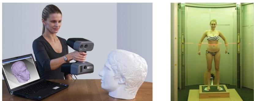
Рис. 15.18. Активное лазерное сканирование
