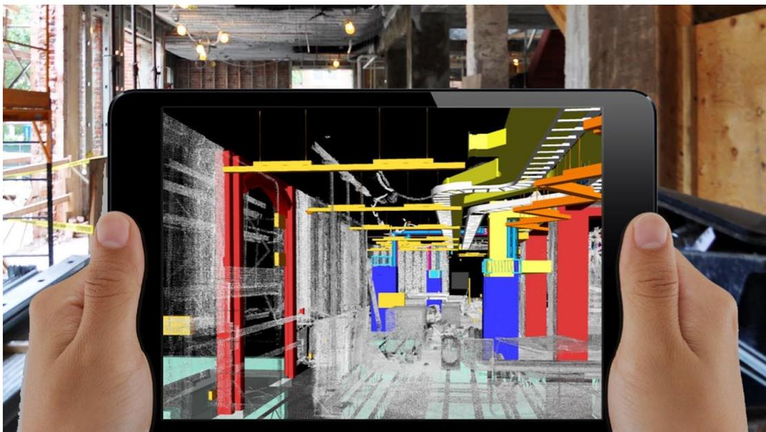
Рис. 12.7. Указание на нагруженные элементы в AR
