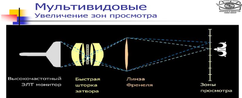
Рис. 10.11. Схема увеличения зон просмотра мультивидового дисплея
