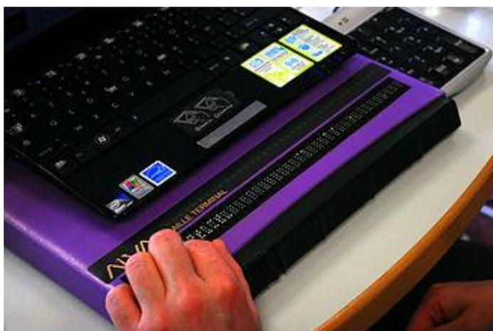
Рис. 9.31. Обновляемый дисплей Брайля с вращающимся колесом
