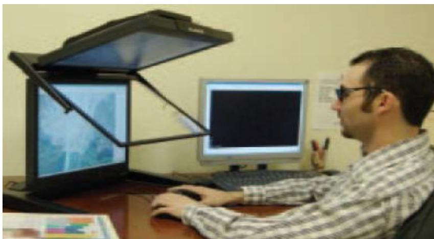
Рис. 10.18. Стереодисплей фирмы Planar
