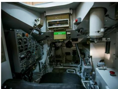
Рис. 16.4. Отделение механика-водителя танка Т-72
