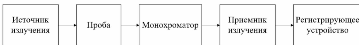
Рисунок 1 – Принципиальная схема спектрометра
