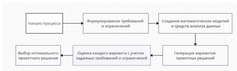
Рисунок 3 – Блок-схема процесса поиска оптимальных проектных решений
